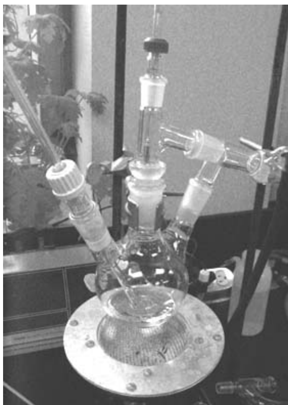
Ballon tricol avec le tube capillaire à gauche et la tête à distiller au-dessus.
