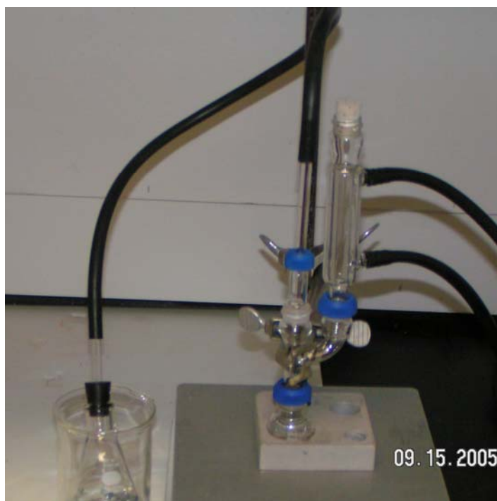
FIGURE 2 Appareil pour effectuer l'hydrogénation catalytique d'un alcène
