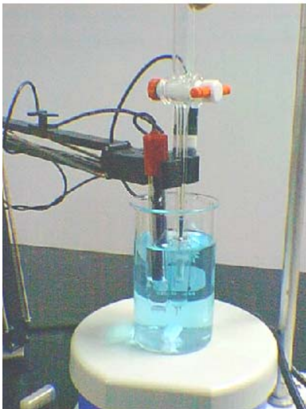
Figure 2. Montage pour effectuer un titrage avec le pH-mètre
